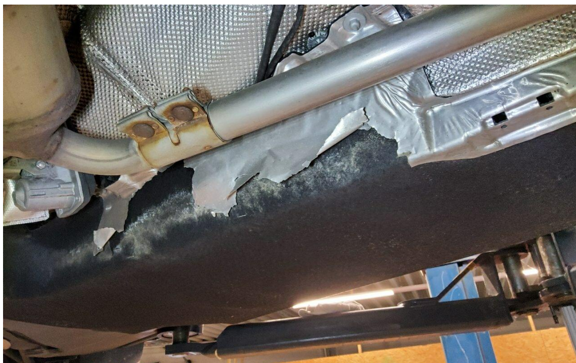
Bild 14 : Wärmeleitblech links gerissen
