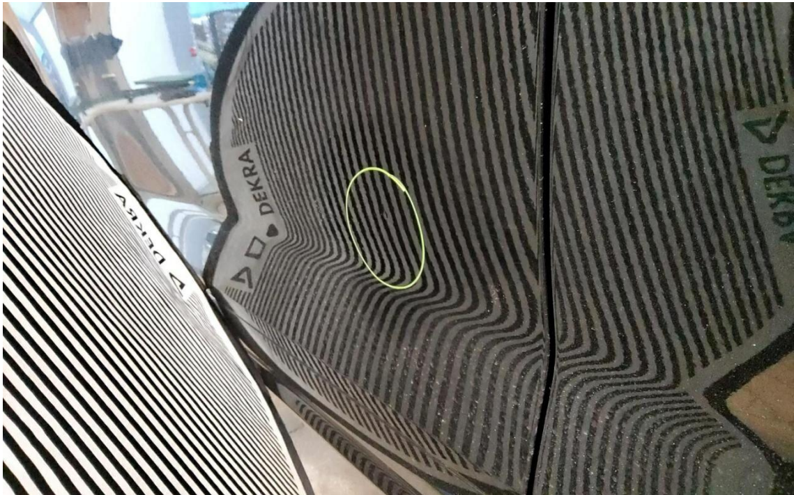
Bild 11 : Tür vorne links, eingedellt, Gebrauchsspur
