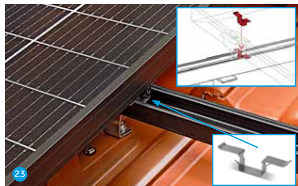
23 Potentialausgleichsklemme unterhalb des Modulrahmens in die Montageschiene drücken. Mit Fixieren der Universal-Modulklemme drückt sich die Klemme in den Aluminiumrahmen und in die Montageschiene und gewährleistet die elektrische Verbindung.
